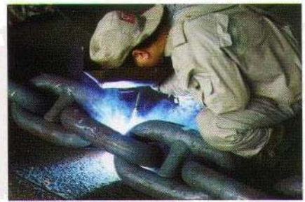
焊档 STUD WELDING
